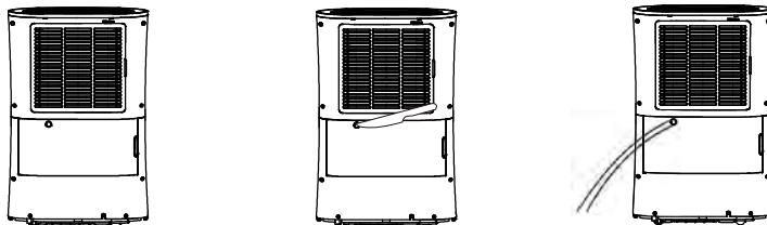
**ΣΗΜΕΙΩΣΗ:** Όταν η λειτουργία συνεχούς αποστράγγισης δεν χρησιμοποιούνται, αφαιρέστε τον εύκαμπτο σωλήνα αποστράγγισης από το στόμιο εξόδου.
