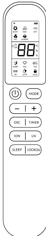
Πιέστε το πλήκτρο TIMER ενώ λειτουργεί η συσκευή, η ένδειξη "clock+OFF" αναβοσβήνει για 5''. Με τα πλήκτρα Πάνω/Κάτω επιλέξτε μεταξύ 1~24 τις ώρες μετά από τις οποίες θέλετε να σβήσει η συσκευή. Πιέστε το πλήκτρο TIMER ενώ η συσκευή είναι σε αναμονή, η ένδειξη "clock+ON" αναβοσβήνει για 5δευτ. Με τα πλήκτρα Πάνω/Κάτω επιλέξτε μεταξύ 1~24 τις ώρες μετά από τις οποίες θέλετε να ενεργοποιηθεί η συσκευή.
