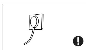
● Χρησιμοποιήστε πρίζα αποκλειστικής χρήσης, η οποία δεν χρησιμοποιείται από κοινού με άλλες ηλεκτρικές συσκευές.
