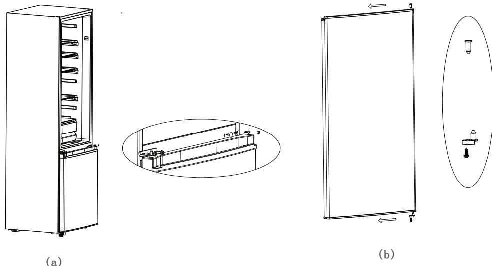
7) Αλλάξτε τη θέση εγκατάστασης του άξονα του πάνω μεντεσέ όπως φαίνεται παρακάτω, μετά τοποθετήστε την πόρτα του ψυγείου στον μεσαίο μεντεσέ και στερεώστε τον επάνω μεντεσέ εφαρμόζοντας βίδες, τέλος για να τοποθετίσετε το κάλυμμα του επάνω μεντεσέ και το καπάκι της οπής.
