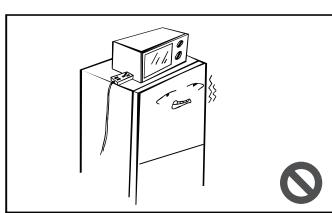
● Μη χρησιμοποιείτε άλλες ηλεκτρικές συσκευές επάνω στη συσκευή, εκτός αν είναι του τύπου που συνιστάται από τον κατασκευαστή.
