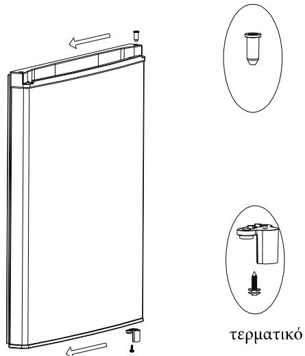
6) Βάλτε την πόρτα του καταψύκτη στον κάτω μεντεσέ, μετά εγκαταστήστε τον μεσαίο μεντεσέ και τα καλύμματα τρυπών (a). Αποσυναρμολογήστε το τερματικό της πόρτας της συντήρησης, και τοποθετήστε το στην άλλη πλευρά βιδώνοντας τις βίδες.
