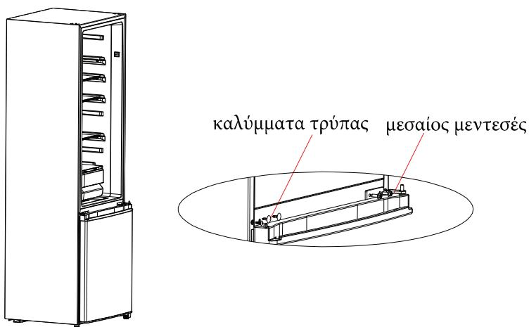
Αφαιρέστε την πόρτα της κατάψυξης και αποσυναρμολογήστε τον κάτω μεντεσέ και το αριστερό ρυθμιζόμενο πόδι.
